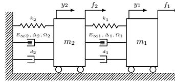
Figura 1: Sistema com 2 graus de liberdade e amortecedor viscoelástico
