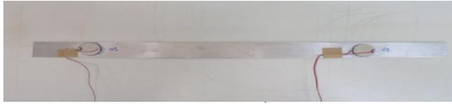
Figura 1: Viga Instrumentada com piezoelétricos.
