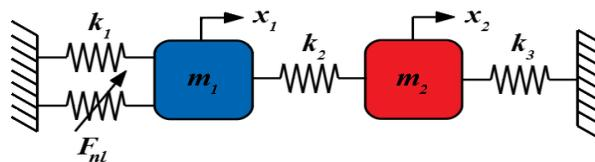
Figura 1: Esquema de um sistema mecânico com dois graus de liberdade.
