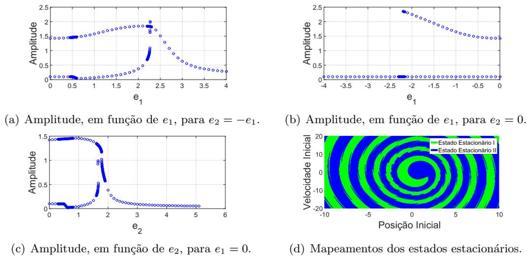
Figura 1: Dependência da amplitude das oscilações em relação aos parâmetros de  $K(y(t))$  e mapeamento dos estados no plano velocidade inicial *versus* posição inicial.
