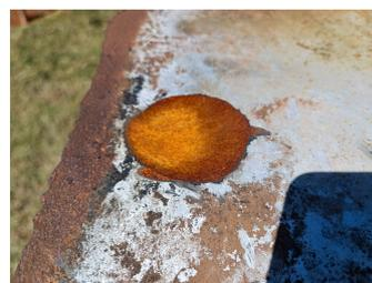
Figura 4: Dano realizado na placa de aço. Fonte: dos autores.
