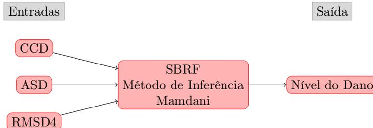
Figura 7: Arquitetura do SBRF para nível de dano. Fonte: dos autores.
