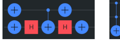
Figura 2: Circuito dos operadores 2|\psi\rangle\langle\psi| - I e U_f , respectivamente. Fonte: Autores.
